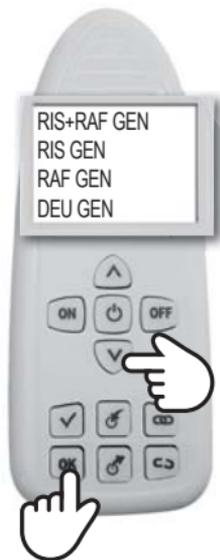
NOTA: después de la operación de INCLUSIÓN, espere 10 segundos antes de realizar la operación sucesiva. En caso contrario, en la pantalla aparecerá el mensaje **ESPERE** y todas las teclas se inhibirán.
