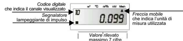
Alla registrazione dell'impulso il contatore d'energia **ECCM2IS1** registra il valore delle temperature e la loro visualizzazione può essere effettuata mediante il pulsante a bordo dello strumento.
