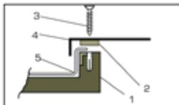
**Fissaggio diretto alla struttura di sostegno con tasselli a espansione:** fissare la base del torrino alla struttura di sostegno mediante tasselli ad espansione aventi diametro non superiore a 10 mm
