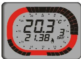
Sul display si legge in ogni momento la temperatura ambiente, l'ora e il giorno della settimana in corso, l'eventuale richiesta di calore (o di raffreddamento in estate\*) e la segnalazione di carica insufficiente delle pile.
