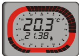
Sul display si legge in ogni momento la temperatura ambiente, l'ora in corso, l'eventuale richiesta di calore (o di raffrescamento in estate) e la segnalazione di carica insufficiente delle pile.
