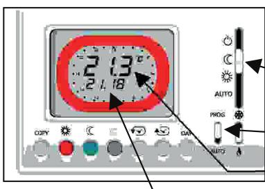
Mit Intellitherm C55 ist es möglich, die MINDEST- und HÖCHSTTEMPERATUR zu prüfen, die die Umgebung am Vortag erreicht hat sowie die Uhrzeit, zu der sie gemessen wurde.
