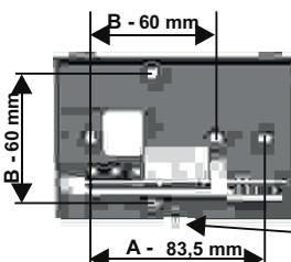
DIESE SCHRAUBE ABSCHRAUBEN UND DAS GEHÄUSE DES GERÄTS NACH OBEN DREHEN, UM DEN BEFESTIGUNGSSOCKEL ZU ENTFERNEN
