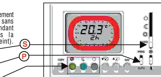
Une fois le temps programmé écoulé, *Intellitherm* reprendra le programme automatique. Pour réduire ou exclure la période JOLLY avant le temps prévu, appuyer sur un bouton d'une couleur différente de celle de la couronne sur l'écran.
