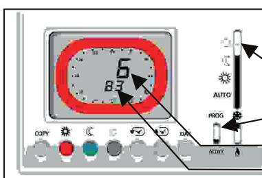
Con Intellitherm C55 es posible saber durante cuántas horas ha sido "requerido calor" (relé cerrado ON) el día anterior y desde el inicio del funcionamiento de Intellitherm (es decir, desde la colocación de las pilas o desde un reset).
