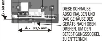
DIESEN SCHRAUBE ABSCHRAUBEN UND DAS GEHÄUSE DES GERÄTS NACH OBEN DREHEN, UM DEN BEFESTIGUNGSSOCKEL ZU ENTFERNNEN
