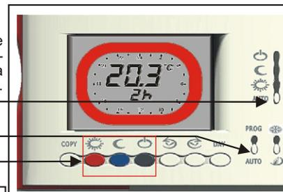
Trascorso il tempo impostato *Intellitherm* riprenderà il programma automatico. Per ridurre o escludere il periodo **JOLLY** prima del tempo previsto, premere un tasto di colore diverso di quello della corona sul display.
