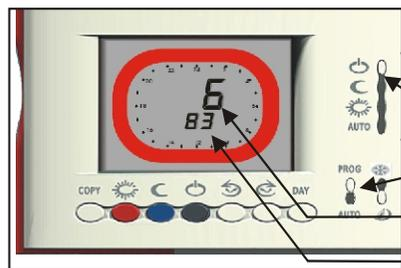
Con Intellitherm C75 è possibile sapere per quante ore è stato "richiesto calore" (relè chiuso - ON) il giorno precedente e dall'inizio del funzionamento di Intellitherm (cioè dall'inserimento delle pile o da un reset).
