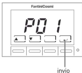
I parametri di configurazione sono rappresentati sul display da un indice: P01, P02....
