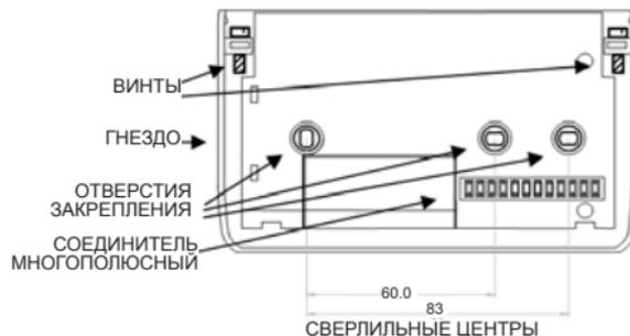
Устраните верхнее покрытие термостата. Отделите гнездо и внешнюю часть термостата, устраняя винт посредством подходящего инструмента и снимая переднюю часть. Закрепите гнездо к желаемой поверхности посредством специальных отверстий закрепления; удостоверьтесь, что гнездо должным образом установлено, без деформации, и чтобы многополюсный соединитель был расположен в правильном нижнем углу.
