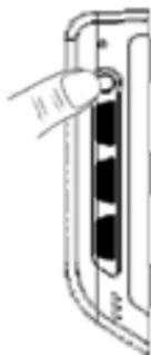
Per passare dal funzionamento invernale (impianto di riscaldamento) al funzionamento estivo (impianto di raffreddamento), e viceversa, tenere premuto per almeno 4 secondi il tasto Estate / Inverno. Il funzionamento selezionato viene indicato sul display dalle icone Inverno o Estate.
