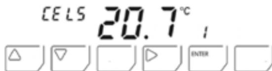
Ogni parametro di configurazione, che ha delle impostazioni predefinite, è identificato sul display da un indice e da una scritta. Per modificare i valori di un parametro usare i tasti ▲ [tasto 1] e ▼ [tasto 2]; per spostarsi fra i parametri usare il tasto ► [tasto 4].
