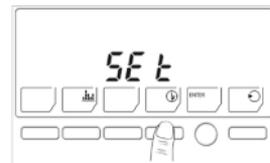
2. Se déplacer à l'aide de la touche ► jusqu'à mettre en évidence l'humidité réglée.
