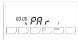
3. Página 2: horas totales de encendido del sistema desde la primera puesta en funcionamiento (en la imagen, 16 horas).
