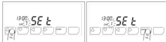
5. Presionar nuevamente ENTER para salir del menú de programación. El cronotermostato retorna el modo de funcionamiento interrumpido anteriormente.
