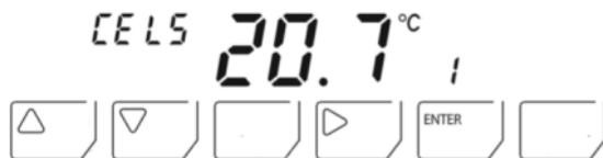
Cada parámetro de configuración, que tiene configuraciones predefinidas, es identificado en la pantalla por un índice y un mensaje. Para modificar el parámetro actual usar las teclas ▲ [tecla 1] y ▼ [tecla 2]; para desplazarse entre
