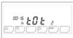
Utiliser la touche ► pour passer à la page suivante. Appuyer simultanément sur les touches ▲ et ▼ pour mettre à zéro les heures totales d'allumage.
