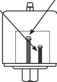
Regolazione della pressione di attacco: avvitando aumenta il valore di pressione
