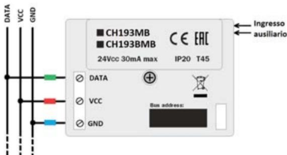
L'ingresso ausiliario è utilizzabile per il collegamento di una sonda di temperatura esterna (mod. EC18, EC19, EC20), oppure di un contatto ON/OFF allarmabile. Ai morsetti si accede rimuovendo il coperchio
