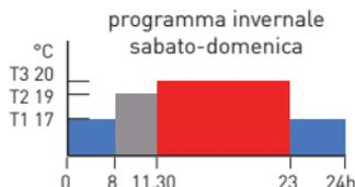
Il valore delle 4 temperature è programmabile utilizzando la funzione TEMP.
