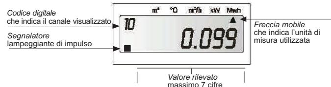
Alla registrazione dell'impulso il contatore d'energia ECCM21 registra il valore delle temperature e la loro visualizzazione può essere effettuata mediante il pulsante a bordo dello strumento.
