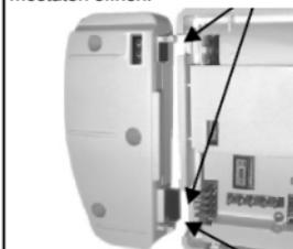
Das Modul rastet durch Druck ein: Achtung auf korrekten Anschluss der Steckverbinder
