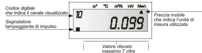
Alla registrazione dell'impulso il contatore d'energia ECCM registra il valore delle temperature e la loro visualizzazione può essere effettuata mediante il pulsante a bordo dello strumento.
