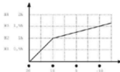
Как для температуры сетевой воды, заблаговременность включения вычисляется автоматически интерполяцией, используя установленные значения заблаговременного включения для 4-х значениях внешней температуры. Значения заблаговременности включения устанавливаются в том же самом меню, который используется для назначения тех 4-х значениях температуры. Максимальное значение, которое может быть
