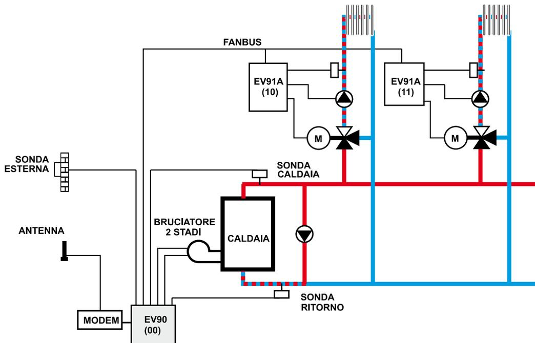
COMANDO DI DUE CALDAIA IN CASCATA
