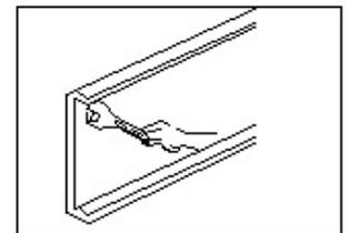
5. Appendere l'unità alla staffa di fissaggio e avvitare le viti di fissaggio poste sotto la barriera d'aria.
