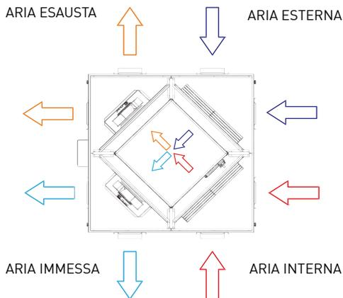
Gli attacchi di immissione/espulsione possono essere configurati come raffigurato in schema e direttamente in fase di installazione in cantiere.
