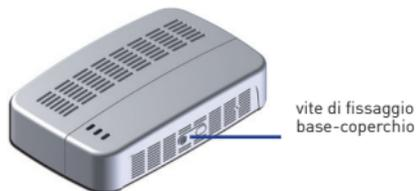
Dopo il fissaggio e dopo aver eseguito i collegamenti (vedere paragrafo 4) rimontare il coperchio sulla base, facendo attenzione che i due dentelli del coperchio alloggino perfettamente nelle due guide superiori. Riavvitare la vite di fissaggio ed applicare nella sede prevista l'etichetta autoadesiva fornita indicante la data di sostituzione.
