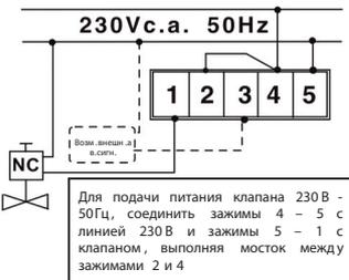
Пример соединения прибора Sicurgas P61A-P62A - с ИМПУЛЬСНЫМ РЕЛЕ , с ПУСКОМ ТОКА для управления клапаном с ручным восстановлением , нормально разомкнутым NC (мосток в верхней позиции)
