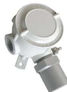
Alimentazione 11÷28Vdc. Elemento sensibile Catalitico, Pellistor (opzionale) o Semiconduttore (opzionale) per gas infiammabili, e cella elettrochimica o Semiconduttore (opzionale) per gas tossici. Fino a tre soglie di intervento. Led sull'elemento sensibile per l'indicazione dello stato di funzionamento. Conteggio automatico del tempo di vita dei sensori.
