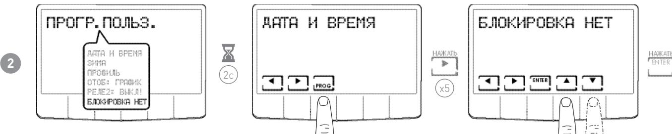
**Примечание:** при выборе BLOCCO SI (БЛОКИРОВКА ДА), отображается кнопка ОК. Следовательно, выполнить процедуру описанную в пунктах 3 и 4.
