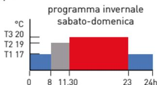
Il valore delle 4 temperature è programmabile utilizzando la funzione TEMP.
