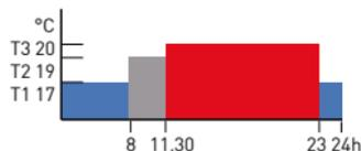
Il valore delle temperature è programmabile utilizzando la funzione TEMP.
