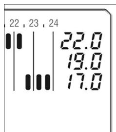
La **temperatura T2** non può essere superiore alla temperatura T3 o inferiore alla temperatura T1.
