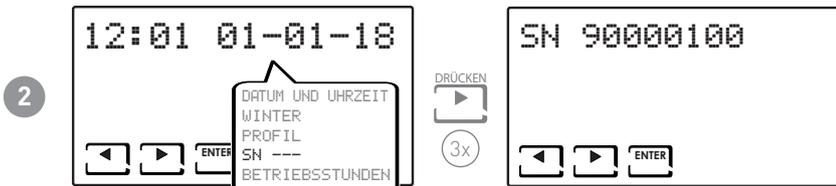
**Anmerkung:** Diese Nummer identifiziert das einzelne Gerät und wird für die WLAN-Aktivierung über die App „Intelliclimate“ verwendet.
