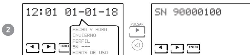
**Nota:** este número identifica el dispositivo y se utiliza para la activación WiFi con la aplicación "Intelliclimate+".
