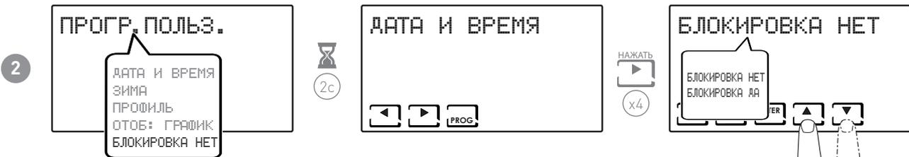
**Примечание:** при выборе БЛОКИРОВКА ДА, отображается кнопка ПРОГ. После этого следует выполнить процедуру описанную в пунктах 3 и 4.
