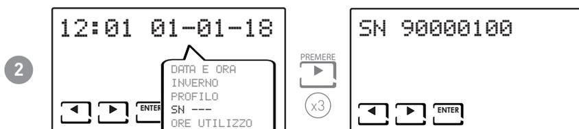
**Nota:** questo numero identifica il singolo dispositivo ed è utilizzato per l'attivazione WiFi tramite l'app "Intelliclimate+".
