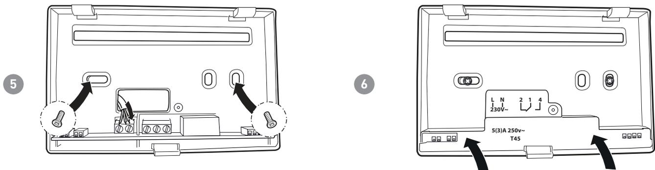
Die angegebene Schraube anziehen und das Gehäuse an den Wandschalter anhängen.
