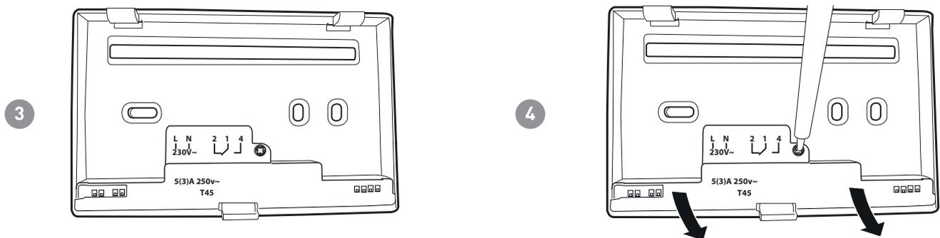
Elektrische Anschlüsse ausführen (s.Absatz „Elektrische Anschlüsse“) und den Sockel mit den mitgelieferten Schrauben an der Wand befestigen.
