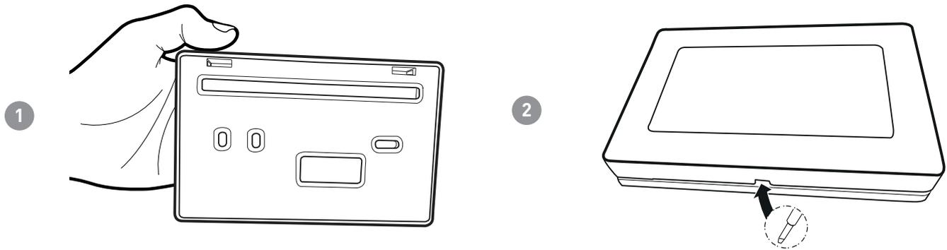
Den Isolierschutz durch Abschrauben der wasserundurchlässigen Schraube entfernen.
