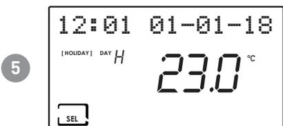
Wenn die Tastatur gesperrt ist, kann nur die Taste SEL gedrückt werden. Nach Druck auf die Taste SEL kann das gewählte Passwort eingegeben und damit die Tastatur freigegeben werden.
