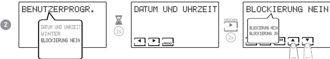
**Anmerkung:** Bei Auswahl von BLOCKIERUNG JA wird die Taste PROG angezeigt. Dann die unter Punkt 3 und 4 beschriebene Prozedur durchführen.
