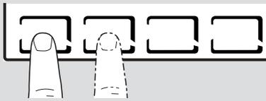
Der erste Druck auf irgendeine Touch-Taste bewirkt die Aktivierung der Funktionen der Tasten selbst und die Beleuchtung des Displays.
