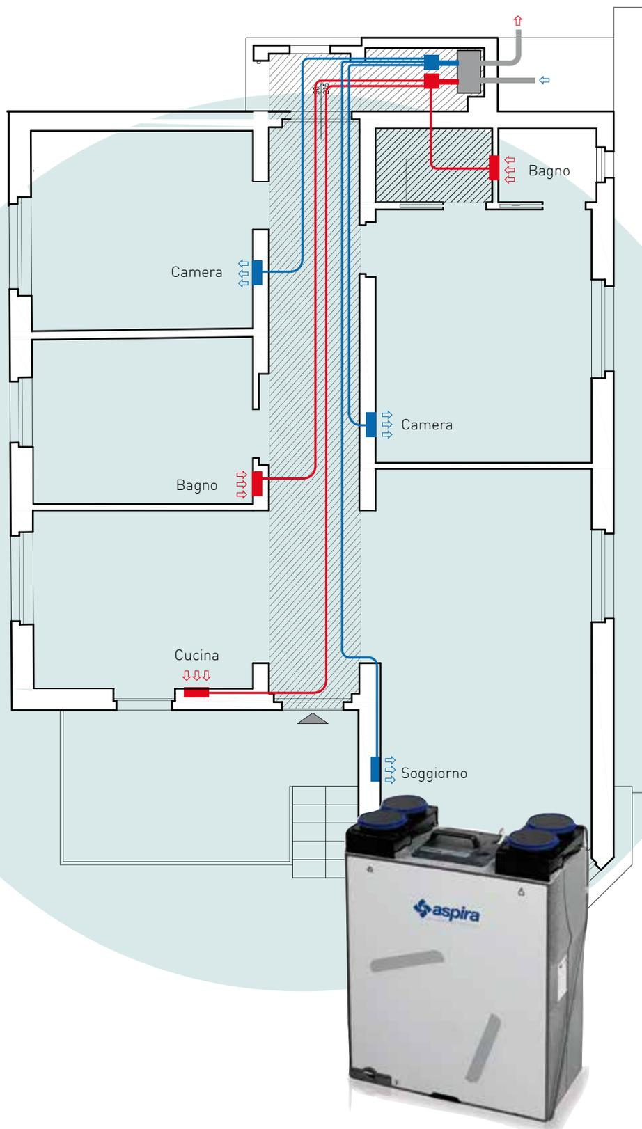
Un impianto di ventilazione meccanica controllata a doppio flusso con recupero di calore è un sistema evoluto di ventilazione che permette **l'estrazione dell'aria viziata dai locali "umidi"**, ossia a più alta concentrazione di inquinanti, quali le cucine, i servizi igienici e, se esistenti, le lavanderie, e la contemporanea **immissione di aria nuova negli nei cosiddetti locali "nobili"** come le camere da letto e il soggiorno.
