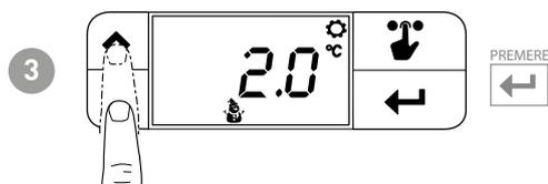
**Nota:** valore di default 2,0°C, valore impostabile da 2,0°C al valore impostato in P7 meno 0,1°C (se imposti P7 al valore 25,0°C, il valore massimo impostabile di P8 sarà 24,9°C)
