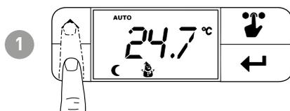
**Nota:** con le frecce si modifica il valore di temperatura tE o tC (a seconda che sia impostato tE o tC). La prima pressione del tasto non modifica il valore ma fa vedere il setpoint. In inverno tE < tC; in estate tC < tE
