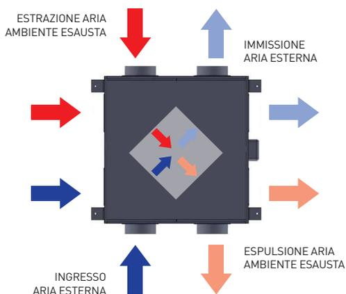
Differenti configurazioni disponibili. Configurazione standard D3. I condotti circolari di mandata e di ripresa possono essere installati indifferentemente su ciascun lato del recuperatore nel momento dell'installazione, dunque la configurazione standard D3 è adattabile a quasi tutte le situazioni.
