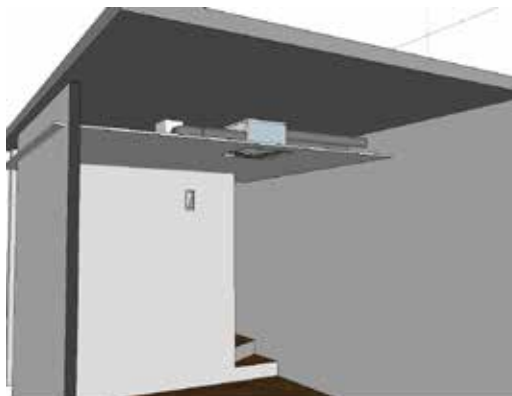
Installazione in controsoffitto
