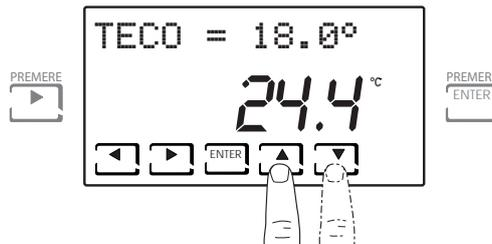
**Nota:** la regolazione non è in funzione della temperatura ambiente letta dal sensore del CH193VMC ma dalla sonda AIR interna alla VMC (vedi paragrafo “6.5 - AIR (SONDA DI TEMPERATURA DELL'ARIA DI RIPRESA INTERNA ALLA VMC)”).
