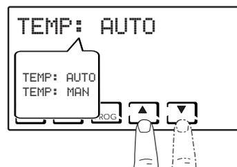
**Nota:** è possibile impostare la macchina con un funzionamento manuale (T MAN) e uno automatico (T ECO/TCOMF). Alla selezione di TEMP: AUTO viene visualizzato il tasto PROG, seguire quindi la procedura descritta al punto 3 e 4.
