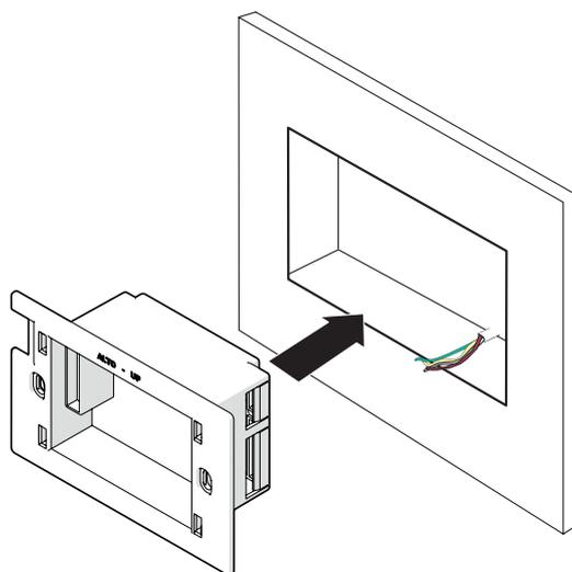
Eeguire i collegamenti elettrici (fare riferimento al paragrafo "2 - COLLEGAMENTO ELETTRICO") e fissare il corpo posteriore a parete con le viti in dotazione.
