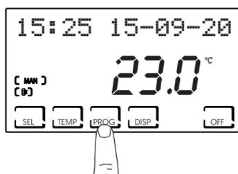
Se la macchina è predisposta per integrare il riscaldamento e/o raffreddamento è possibile impostare il set point della temperatura con programma settimanale (con risoluzione ogni 30 minuti) oppure manuale.
