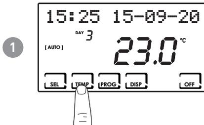
È possibile impostare un valore di temperatura T ECO (Temperatura di economy) e T COMF (Temperatura di comfort) compresa tra 5 e 35° C.
