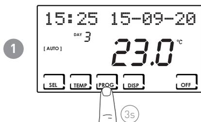
Definisce il valore massimo del range di funzionamento del set point impostabile fra 5 e 35°C.
