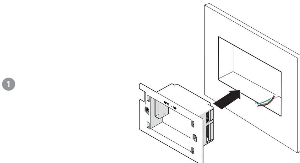
Eeguire i collegamenti elettrici (fare riferimento al paragrafo "2 - COLLEGAMENTO ELETTRICO") e fissare il corpo posteriore a parete con le viti in dotazione.
