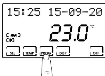
Se la macchina è predisposta per integrare il riscaldamento e/o raffrescamento è possibile impostare il set point della temperatura con programma settimanale (con risoluzione ogni 30 minuti) oppure manuale.
