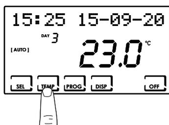
È possibile impostare un valore di temperatura T MAN (Temperatura manuale) compresa tra 5 e 35°C.
