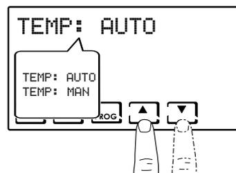
**Nota:** è possibile impostare la macchina con un funzionamento manuale (T MAN) e uno automatico (T ECO/TCOMF). Alla selezione di TEMP: AUTO viene visualizzato il tasto PROG, seguire quindi la procedura descritta al punto 3 e 4.
