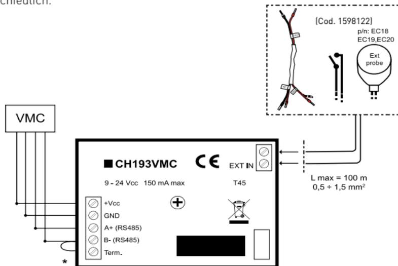
**\*Remarque :** effectuer un pont entre les bornes. Utiliser un câble blindé et mettre-le à la terre à côté CH193VMC.
