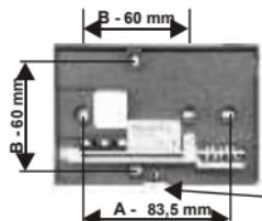
A = für Einbaugehäuse 503 (3 Module)
