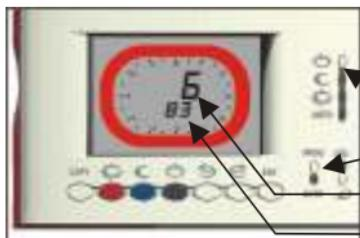
Mit Intellitherm C75 ist es möglich, zu erfahren, über wieviele Stunden am Vortag und ab dem Betriebsbeginn des Intellitherm „Wärme gewünscht“ wurde (Relais geschlossen – ON), (d.h. ab dem Einsetzen der Batterien oder ab einem Reset).
