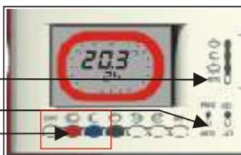
Une fois le temps programmé écoulé, *Intellitherm* reprendra le programme automatique. Pour réduire ou exclure la période **JOLLY** avant le temps prévu, appuyer sur un bouton d'une couleur différente de celle de la couronne sur l'écran.
