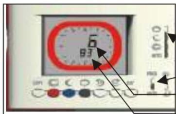
Con Intellitherm C75 è possibile sapere per quante ore è stato "richiesto calore" (relè chiuso - ON) il giorno precedente e dall'inizio del funzionamento di Intellitherm (cioè dall'inserimento delle pile o da un reset).
