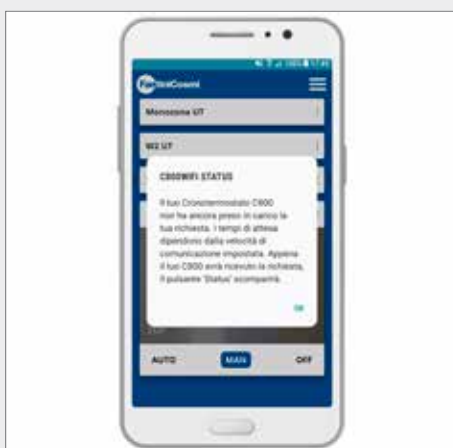
45. L'avviso che appare quando si preme il tasto/icona STATUS, ossia è stato impartito un comando dall'APP, preso in carico dal SERVER, ma che è in attesa di essere preso in carico dal cronotermostato.
