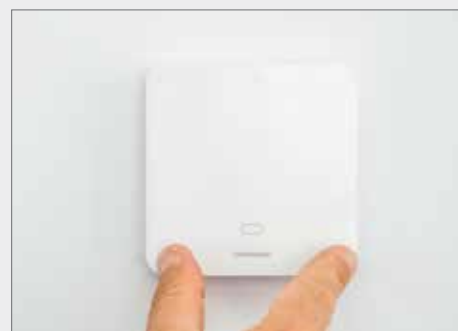
11. Applica l'unità elettronica sugli agganci posti sul lato superiore della base fissata alla parete, quindi premi per agganciarla completamente.
