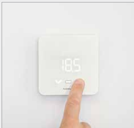
20. Premi i tasti UP e DOWN per impostare il setpoint al valore desiderato.
