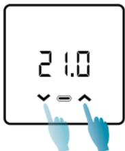
Durch Drücken der Pfeile UP oder DOWN kann der gewünschte Temperaturwert (Set Point) der aktuellen Betriebsart geändert werden. Der Wert wird in Schritten von 0,1°C erhöht oder verringert.
