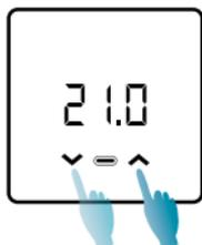
Pulsando las flechas UP o DOWN se puede cambiar el valor de temperatura deseado (Punto de Consigna) del modo de funcionamiento actual. El valor aumenta o disminuye en pasos de 0,1°C.
