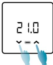
En appuyant sur les flèches UP ou DOWN, la valeur de la température désirée (Set Point) du mode de fonctionnement actuel peut être modifiée. La valeur est augmentée ou diminuée par paliers de 0,1°C.
