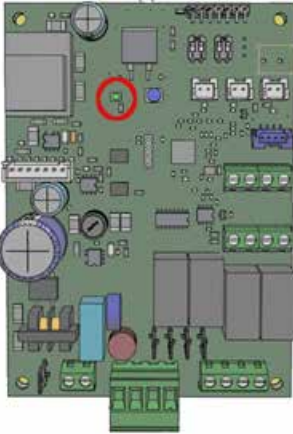
1 LED SEGNALAZIONE ALLARMI SCHEDA UNITA'
