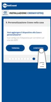
Una volta completata la configurazione del comando remoto è possibile scegliere **TERMINA** per confermare i parametri selezionati ed uscire dal menù; oppure scegliere **CONFIGURA** per proseguire la configurazione anche con il passaggio "9. PERSONALIZZAZIONE COMANDO REMOTO NELLA CASA".
