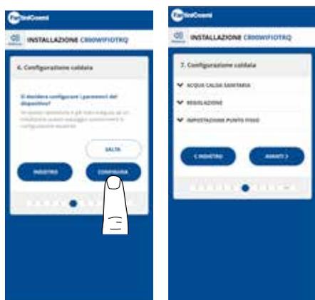
È possibile scegliere se configurare subito i parametri dell'impianto caldaia, oppure saltare questo passaggio e continuare solo con la personalizzazione del dispositivo nella casa (vedasi passaggio "9. PERSONALIZZAZIONE COMANDO REMOTO NELLA CASA").
