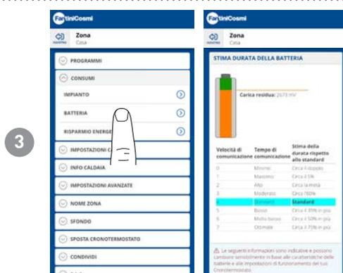
Visualizzazione dello stato della batteria e della stima della sua durata in funzione del tempo di comunicazione impostato.
