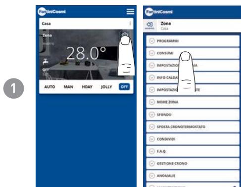
Dall'APP è possibile visualizzare i consumi dell'IMPIANTO (ore di funzionamento), del comando remoto (carica della BATTERIA), ed il RISPARMIO ENERGETICO ottenuto tramite le funzioni smart del C800WIFIOTRQ.
