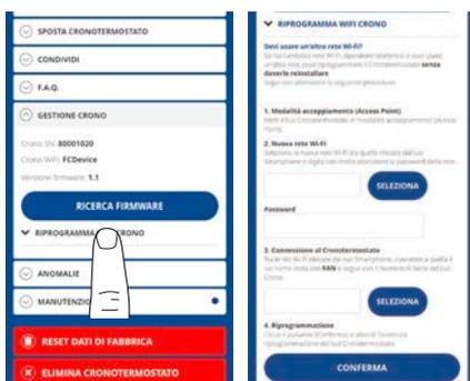
Se si cambia router, è possibile agganciare il comando remoto al nuovo router senza dover rifare l'installazione da capo.
