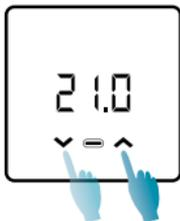
Bei eingeschaltetem Display können Sie durch Drücken der Pfeiltasten UP oder DOWN den gewünschten Temperaturwert (Einstellwert) im aktuellen Betriebsmodus ändern. Der Wert wird in Schritten von 0,1°C erhöht oder verringert.
